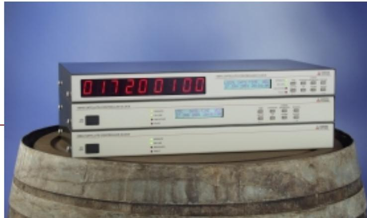
El reloj controlado por satélite Modelo 1084A/B/C de Arbirer Systems®, Inc., provee en un paquete económico las características más esenciales de los relojes GPS. Tres versiones le permiten cubrir sus requerimientos. En el Modelo 1084A, cuatro leds monitorean el estado de operación. El Modelo 1084B añade una pantalla de cristal líquido (LCD) y un teclado para la operación y el estado; el Modelo 1084C también incluye una gran pantalla de leds (de 20mm o 0.8") para el tiempo.
